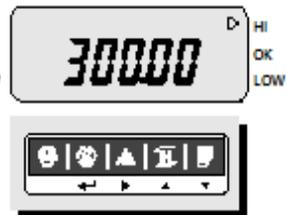
⑥ При помощи клавиш **HOLD(▲)** и **PRINT(▼)** установите значение верхнего предела нагрузки.
