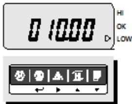
④ При помощи клавиш **HOLD(▲)** и **PRINT(▼)** установите значение нижнего предела нагрузки.
