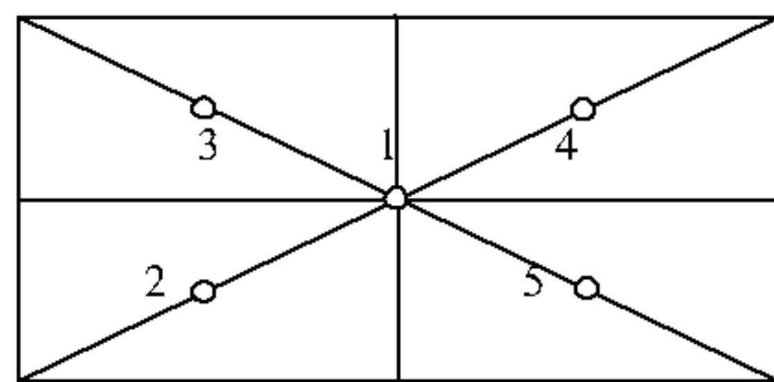
Гири не должны выходить за пределы платформы. При каждом положении гирь регистрируются показания весов. Погрешности весов при нецентральном положении нагрузки рассчитывают по формулам (2) и (3).
